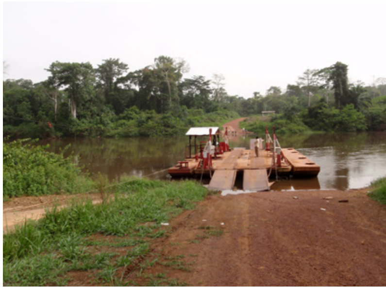
写真③ブンバ(Boumba)川の渡し船。ケーブルを文字通り手繰り寄せて渡る
