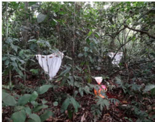
写真②落ち葉(リターフォール)を集めるネットと森の中の雨(林内雨)を集めるバケツ
