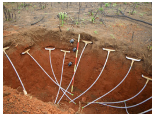
写真③土の中を浸透する水(土壌水)を集める装置
