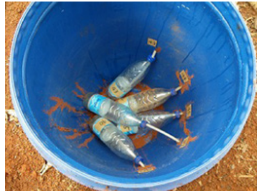
写真④シロアリに侵された土壌水採取装置
